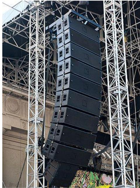
**FIGURE A.1.9 – Système Line Array et Line Source, V-DOSC de chez L-Acoustics.**
